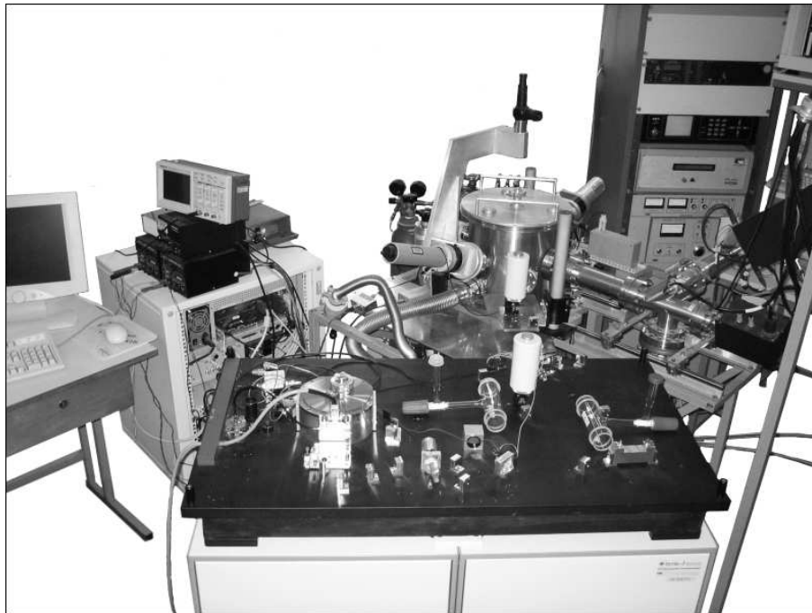
Abbildung 3.1: Foto der Anlage. Im Vordergrund steht der optische Tisch des TDLAS-Systems. Dahinter links die Elektronik zur Lasersteuerung und Datenaufnahme. Dahinter rechts die Vakuumkammer mit dem Ellipsometer. Rechts oben der RF-Generator und Kontrollgeräte zur Prozessführung.
